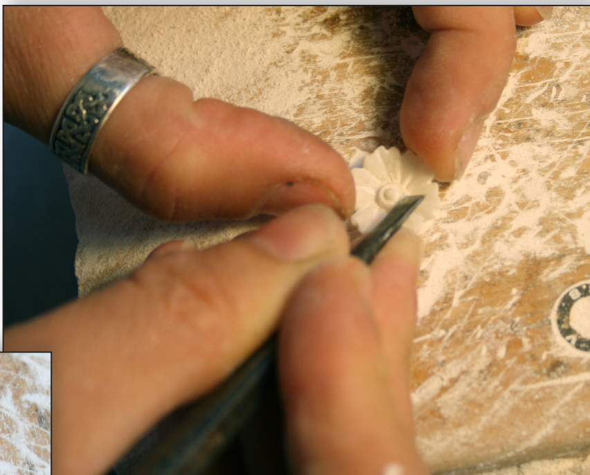
Tornitura, sagomatura e lavorazione con ferri a mano
